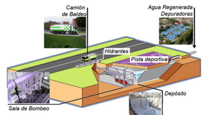
Aprovechamiento de aguas recicladas 9
